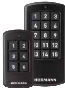
Industrie-Handsender HSI 6 BS, HSI 15 BS zur Ansteuerung von bis zu 6 Toren (HSI 6 BS) bzw. 15 Toren (HSI 15 BS), mit extra großen Tasten zur leichteren Bedienung mit Arbeits- handschuhen, stoßfestes Gehäuse Schutzart IP 65
