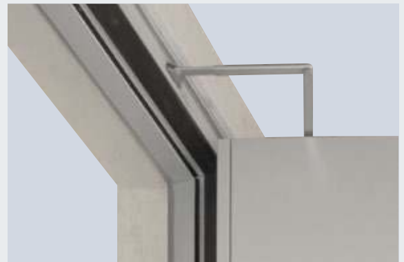
Blockzarge 140 / 75 mm, 3-teilig mit 3-seitig umlaufender Dichtungsnut
