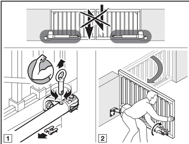
Während eines Spannungsausfalls müssen Sie die Toranlage von Hand öffnen und schließen. Dazu müssen Sie den Antrieb abkuppeln.
